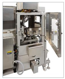
Einfacher, werkzeugfreier Zugriff von beiden Seiten der Maschine.
