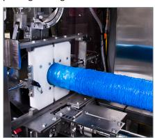
Vollständiger Zugriff zum Austausch von Rohren, Darmbremsen und zur Einstellung des Verdrängerhubs.
