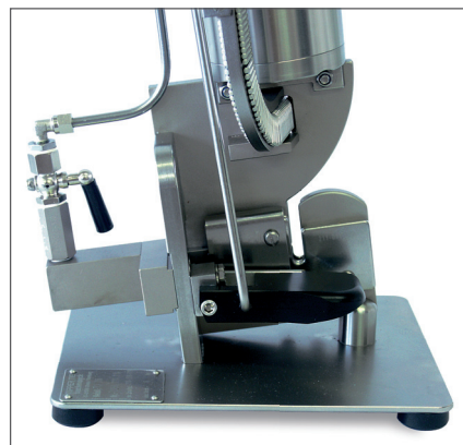
Tasthebelauslösung und abschaltbares Abschneidemesser.
